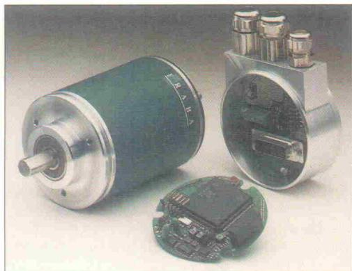
**Hochintegriertes an Bord: Die Elektronik des AWC 65 besteht zur Hauptsache aus einem ASIC, das auch die Profibus-Schnittstelle enthält.**
